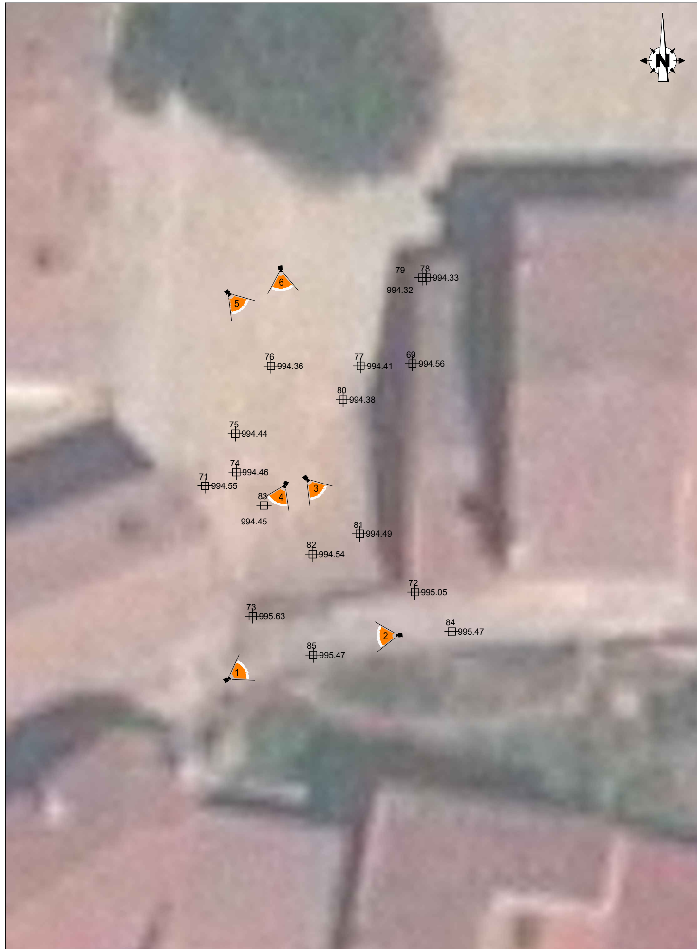
① Levantamiento topográfico y emplazamiento documentación fotográfica
